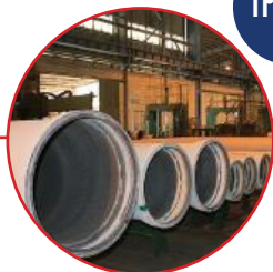
تولید لوله چدن نشکن DN-۸۰ DNY۵۰
